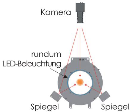
Dank eines Spiegelsystems und einer sehr leistungsstarken Rundumbeleuchtung, die Schatteneinfälle beseitigt, **wird jedes Gemüse einer perfekten 360°-Analyse unterzogen**. Das optische System generiert von jeder Möhre 3 makellose, hochauflösende Bilder. Diese können sofort auf dem Computerbildschirm angezeigt werden um die Fehlererkennung zu kontrollieren.
