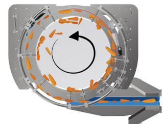
La capacité de tri est **de 1.40 m de pommes de terre et 1.80 m de carottes par seconde**.
