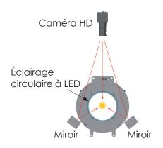
Grâce à un système de miroirs et un éclairage circulaire très puissant, éliminant les effets d'ombre, **chaque produit est parfaitement analysé sur 360°.** Le système optique génère trois images impeccables en haute résolution de chaque pomme de terre. Elles peuvent être affichées instantanément sur l'écran de visualisation de l'ordinateur pour contrôler la détection des défauts.
